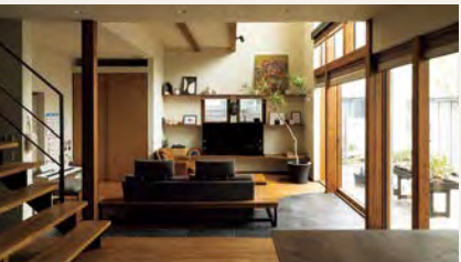
道産のカラマツやタモ材を使用、外との一体感のあるデザイン性が 高い空間でありつつ、計350mmの断熱材や、北海道初となる木 製クワトロ(4重)サッシを採用し、高性能な住宅に。(三五工務店)
